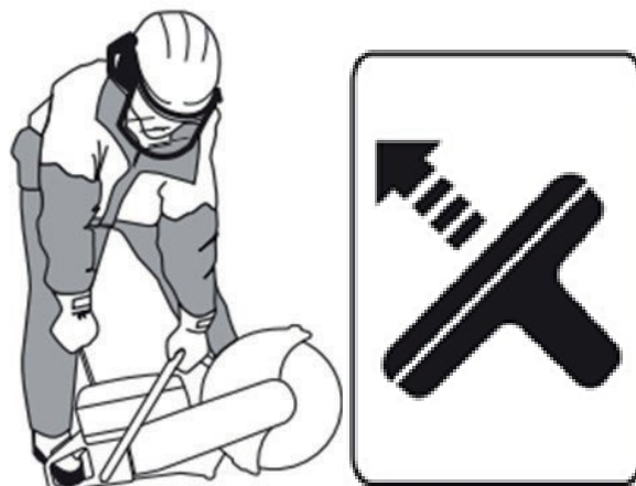
Рис. 11. Запуск бензореза ручным стартером.
